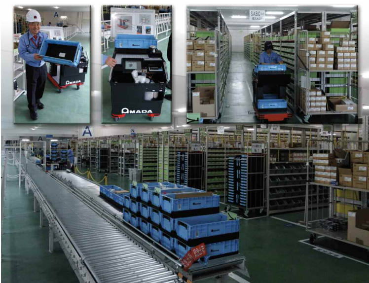
Les pièces détachées demandées seront déposées dans une caisse dotée d'un dispositif de reconnaissance (IC Tag), placée sur un chariot dont le système de tracking guide l'opérateur.
