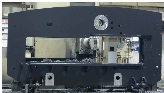
Les bâtis des machines sont usinés après peinture, ce qui permet un gain de temps précieux.
