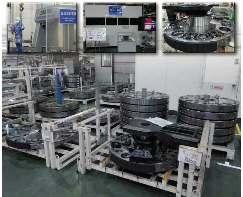
Les tourelles subissent un contrôle 3D au micron et un durcissement avant d'être assemblées manuellement.
