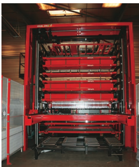
La conception de l'ASLUL F1, avec sa station de chargement dans la partie haute, limite les déplacements des tôles suspendues sous le palonnier à ventouses. Les tôles de 0,8 à 20 mm, posées sur une table de découpe ou une palette, se déplacent en toute sécurité grâce à l'ascenseur.
