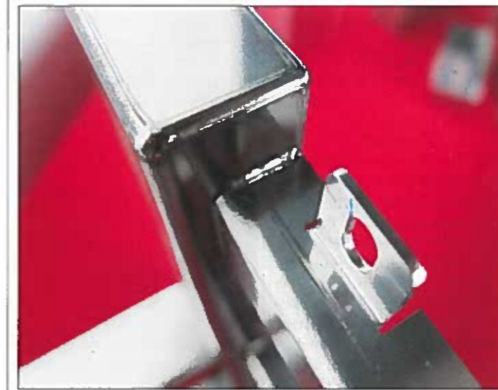
Le résultat : des soudures parfaites ne nécessitant pas de finitions.
