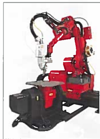
Le robot de soudage laser fibre FLW monté sur rail et équipé d'une table de positionnement.
