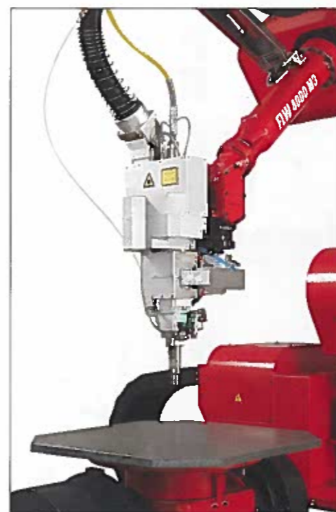
Tête de soudage équipée de sa buse coaxiale.
