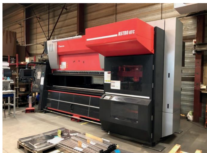
Quelques temps avant l'arrivée de la ligne la société Romaine avait intégré une presse plieuse avec changement automatique d'outils.
